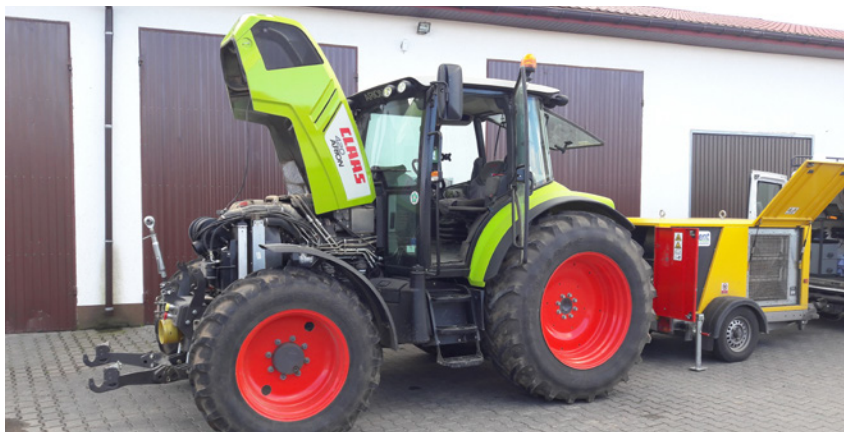
Hamownia WOM Sigma-60 jest najnowocześniejszą hamownią do pomiaru mocy oraz momentu obrotowego w ciągnikach rolniczych. Można przy jej pomocy przeprowadzać badania od mikrociągników aż po kombajny. Można nią z powodzeniem zmierzyć ponad 700 KM i 5000 Nm na WOM.
