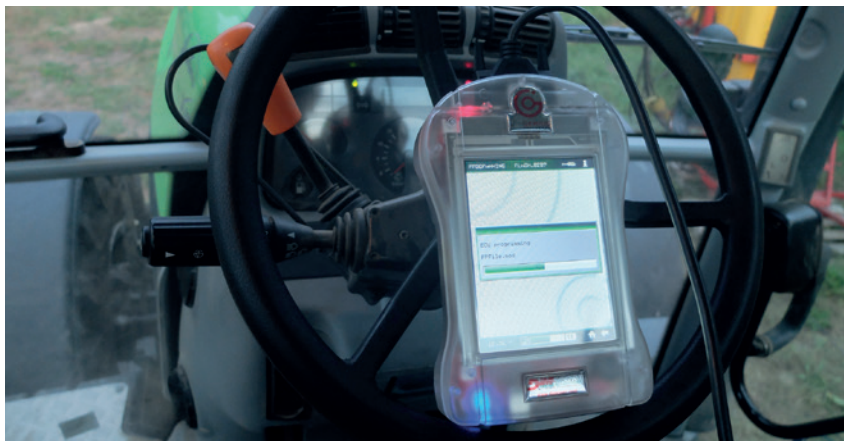
Do programowania używa się programatorów. Jednym z nich jest samodzielna konsola do programowania przez złącze diagnostyczne New Genius firmy DimSport. Umożliwia obsługę bez podłączania do komputera, jest niezawodne i działa z bardzo szeroką grupą traktorów.
